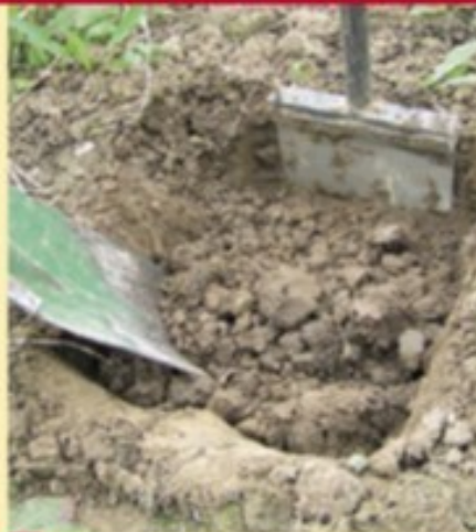
1 Das wird die kleine Grube, in die Sie später den Bodenquader loshebeln. Der zweite Spaten schützt die Profilwand vor unbeabsichtigten Veränderungen.
